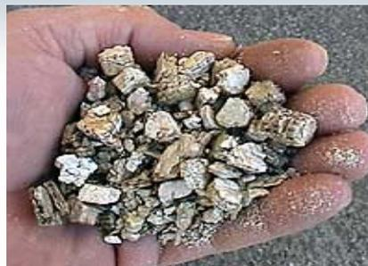
Malheureusement, il se peut que la vermiculite utilisée de cette façon contienne de l'amiante. Ceci est problématique si l'isolant est déplacé, brassé ou manipulé, car il risquera ainsi de libérer des fibres d'amiante dans l'air. Celles-ci peuvent alors être dommageables pour la santé, si elles sont inhalées.
