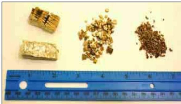
La vermiculite est utilisée dans mille et une applications, soit comme fertilisant pour les sols, agrégat pour le béton léger, dans les matériaux de protection incendie des bâtiments, dans les matériaux intumescents, comme matériel d'emballage pour les matières dangereuses et, tout récemment, comme nanocomposante dans les films, pellicules et enduits.
