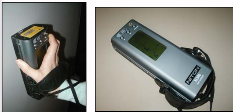
Lecture à l'aide d'un analyseur de spectre (MAP) à fluorescence par rayons X
